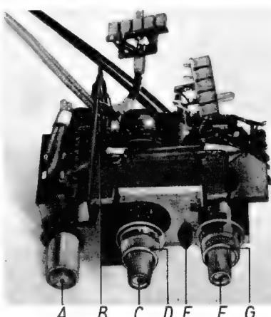
Bild 6. Bedienungseinheit für das Gerät FE 334; A = Netzschalter, B = RC-Glieder (Qualitätspositionen) für Höhen- und Tiefenanhebung, C = Lautstärke, D = Tonblende, E = Befestigungsschraube, F = Helligkeit, G = Kontrast
