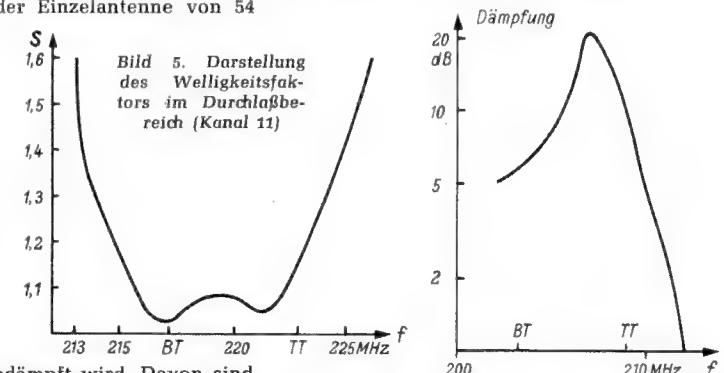
Rechts: Bild 6. Dämpfungsverlauf eines einzelnen Saugkreises
