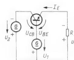
Bild 1. Prinzip der Stabilisierungsschaltung
