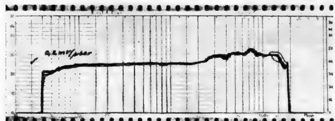
Bild 6. Frequenzgänge von fünf Studio-Richtmikrofonen MD 421
