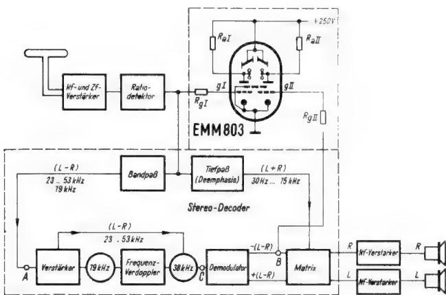
Bild 6. Prinzipschaltbild für die kombinierte Anzeige der Abstimmung und der Stereo-Modulation mit der EMM 803 in einem Stereo-Rundfunkempfänger
