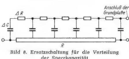
Bild 8. Ersatzschaltung für die Verteilung der Sperrkapazität
