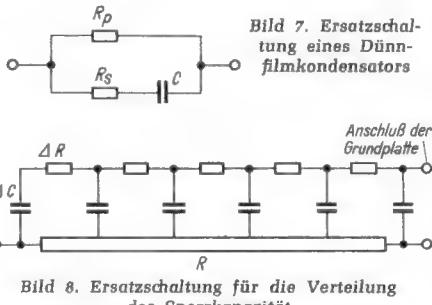
Bild 7. Ersatzschaltung eines Dünnfilmkondensators
