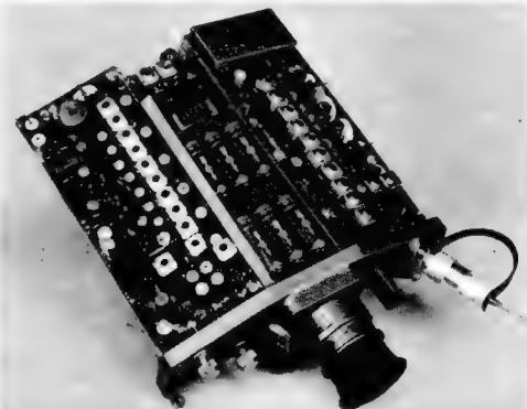
Im Rahmen ihrer Sondergeräte zeigt die SEL auf ihrem Messestand einen Farbfernseh-Kontrollempfänger. Er ist überwiegend mit Transistoren bestückt und mit einer rechteckigen 16-Zoll-Farbbildröhre vom Lochmaskentyp ausgerüstet. Der Monitor ist speziell für Verwendungen im Labor und zur Signalüberwachung in Übertragungsanlagen bestimmt.
