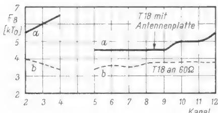
Bild 7. Rauschzahlen in Bereich I und Bereich III, jeweils gemessen mit Antennenplatte (a) bzw. an  $60\Omega$  (b)
