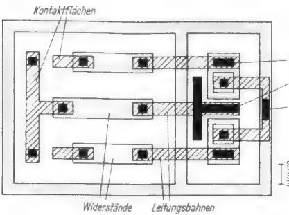
Bild 4. Aufsicht auf einen Schaltkreis in Festkörperteknik
