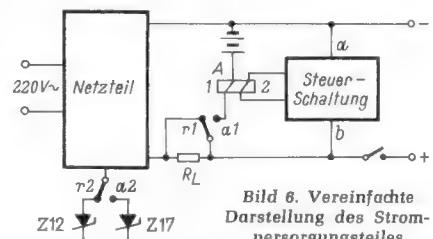
Bild 6. Vereinfachte Darstellung des Stromversorgungssteiles
