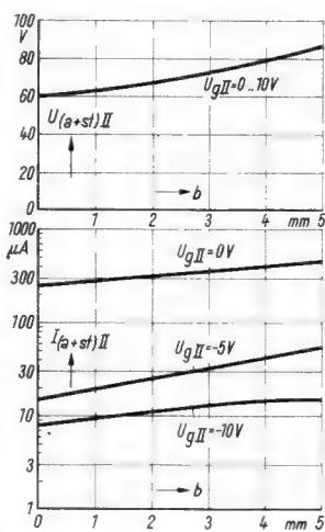
Bild 15. Anodenspannung  $U_{(a+st) II}$  und Anodenstrom  $I_{(a+st) II}$  von System II in Abhängigkeit von der Leuchtbalkenlänge b
