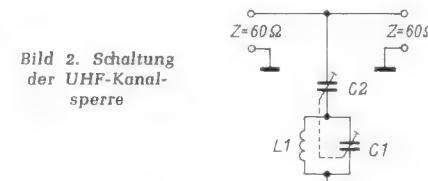
UHF-Signale mit unterschiedlicher Einfallsrichtung werden in Gemeinschaftsanlagen unabhängig von deren Feldstärke mit getrennten Antennen empfangen und direkt an die Verstärkereingänge geführt. Durch die Richtwirkung der Antennen gelangt das jeweils unerwünschte Signal mit verminderterem Pegel an die Verstärkereingänge. Kanalsperren werden hier nur bei sehr großem Unterschied der Feldstärken im Eingangszweig des schwachen Signals nötig sein.
