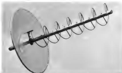
Sturmsichere Wendelantenne für Fernmeßzwecke im 240-MHz-Bereich (Taco Defence and Industrial Division, Sherburne, N. Y., USA)
