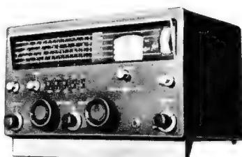
Trennschärfe 800 Hz; 3 kHz; 5 kHz
