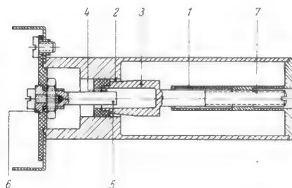
Bild 3. Aufbau der UHF-Kanalsperre; 1 = Innenrohr (Induktivität L1), 2 und 3 = Zylinderbohrung und Kolben (Kapazität C1), 4 und 5 = Innenbohrung und Stift (Kapazität C2), 6 = Kabelklemmung, 7 = Antriebsspirale
