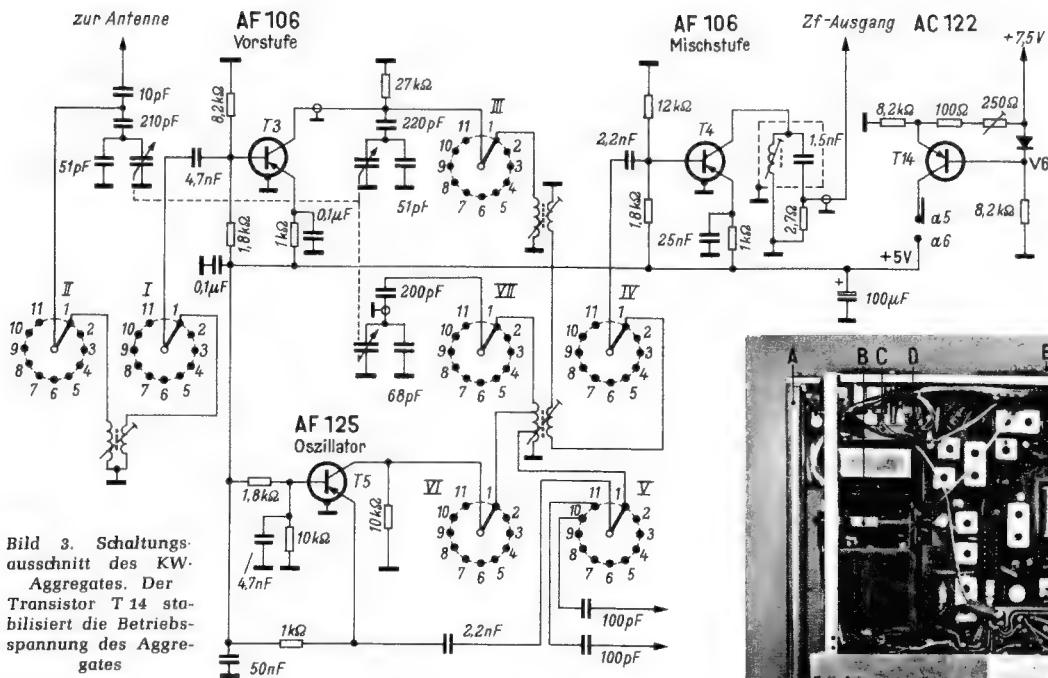
grenzer-Diode begrenzt den Fang- und Haltebereich auf einen konstanten Wert. Die automatische Scharf-Abstimmung ist mit einer Taste abschaltbar. Das Abschalten hat den Vorteil, daß sich das Gerät beim Empfang eines schwachen Senders in unmittelbarer Nähe eines sehr stark einfallenden Senders nicht auf den stärkeren einstellt.
