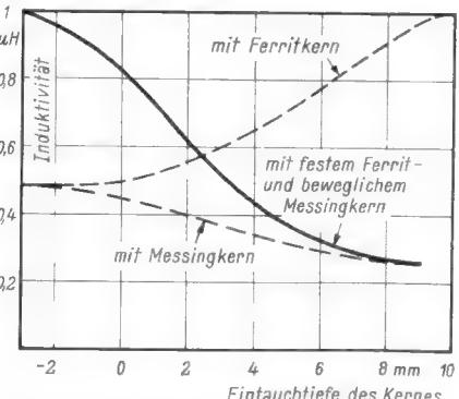
Bild 3. Induktivitätsänderung einer Variometer-Spule bei Verwendung verschiedener Abstimmkerne
