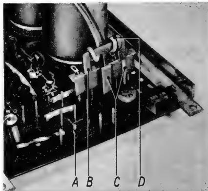
Bild 4. Steckverbindung; A = Kontaktstift, B = Aufnahme für Führungsstift, C = Führungsstifte, D = Zugentlastung
