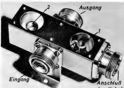
Bild 4. Die praktische Ausführung eines einzelnen Saugkreises
