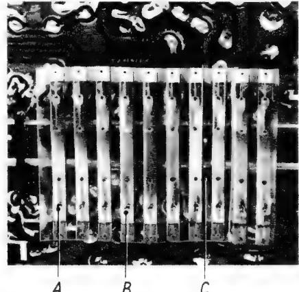
Bild 3. Kontaktverbindung zwischen den Schienengruppen; A = Kontaktstift, B = Schabekonfeder, C = Kunststoff-Folie
