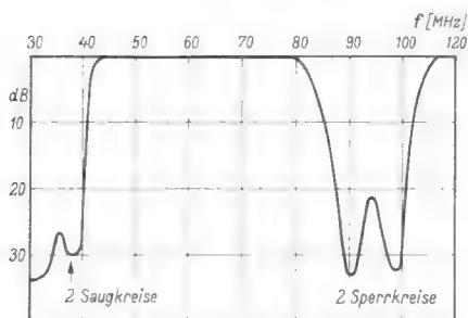
Bild 3. Durchlaßkurve des in Bild 2 dargestellten VHF-Bandpasses
