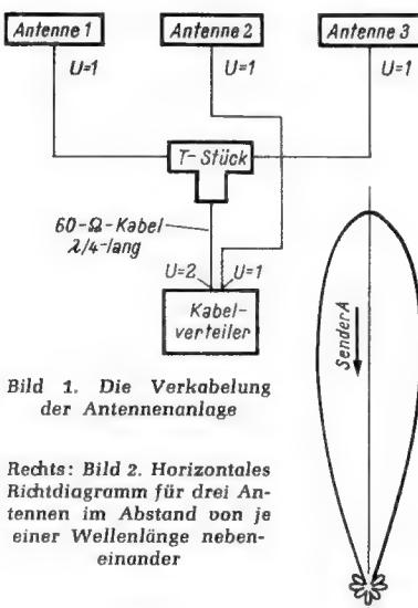
Bild 1. Die Verkabelung der Antennenanlage
