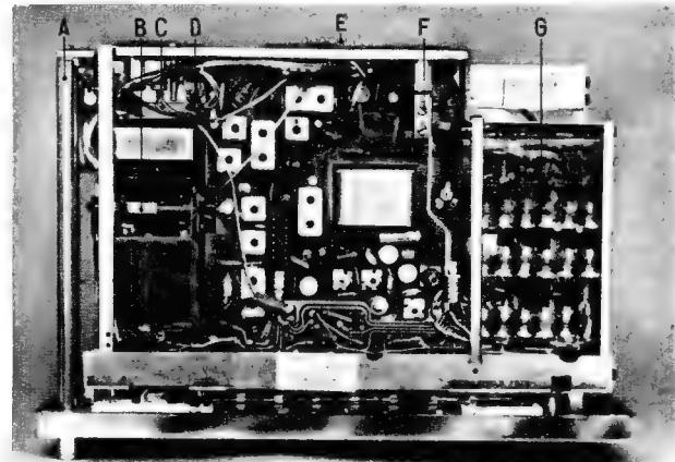
Bei Betrieb des Gerätes im Wagen über die Autohalterung, werden die Eingangskreise des Mittel- und Langwellenbereiches auf Variometer-Abstimmung umgeschaltet. Hierdurch ergibt sich eine gleichbleibende Eingangsempfindlichkeit über den gesamten Bereich.
