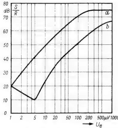
Bild 1. Signal/Rausch-Verhältnis als Funktion der Empfänger-Eingangsspannung ( $f_p = 100 \text{ MHz}$ , Frequenzhub für Pilotfrequenz 7 kHz, für Nf-Signal 40 kHz;  $f_{Nf} = 1 \text{ kHz}$ ,  $L = R$ ) Kurve a = Empfang von monofoner Sendung mit Empfänger mit Entzerrung ohne Decoder, Kurve b = Empfang von stereofoner Sendung
