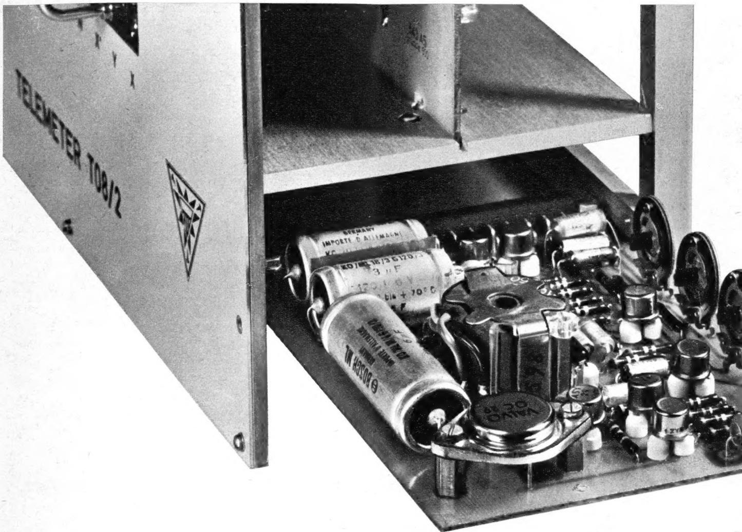
Das Telemeter der Kieler Howaldts-werke AG, Abteilung Apparatebau, erlaubt als Impuls-Echo-Meßgerät (Radarprinzip) die genaue Ortung der verschiedenen vorkommenden Fehler in pupinisierten Kabeln, ohne daß dabei zusätzliche Meßschaltungen notwendig sind.
