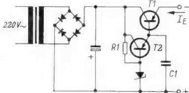
Bild 3. Das stabilisierte Netzteil
