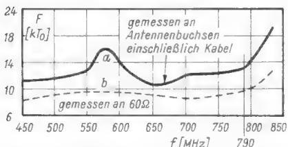
Bild 6. Rauschzahlen im UHF-Bereich, jeweils gemessen an Antennenbuchsen einschließlich Kabel (Kurve a) und an 60Ω (Kurve b)
