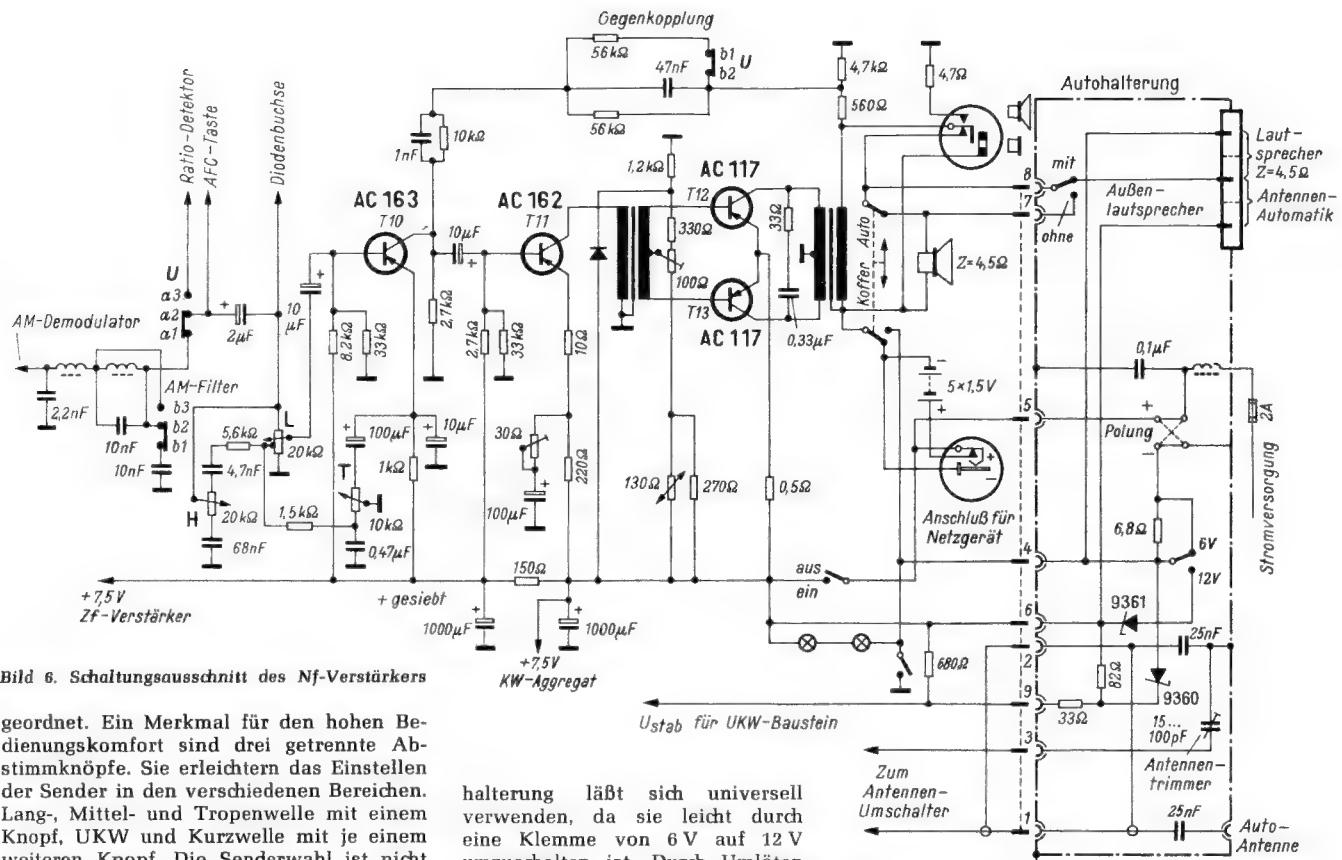
Bild 6. Schaltungsausschnitt des Nf-Verstärkers
