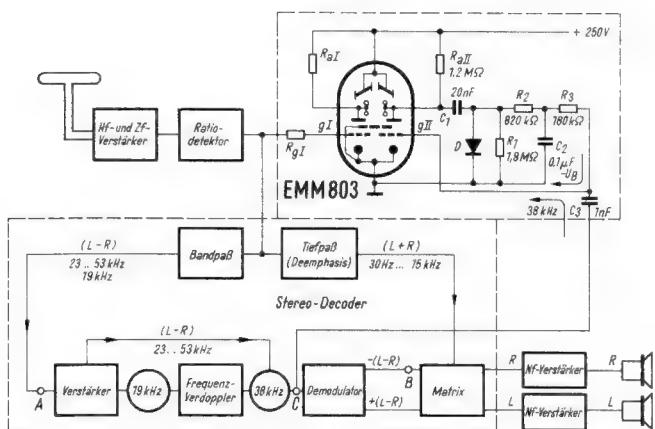
Bild 9. Prinzipschaltbild für die kombinierte Anzeige der Abstimmung und der Stereo-Modulation mit Reflexschaltung zur Verstärkung der Spannung des 38-kHz-Hilfsträgers
