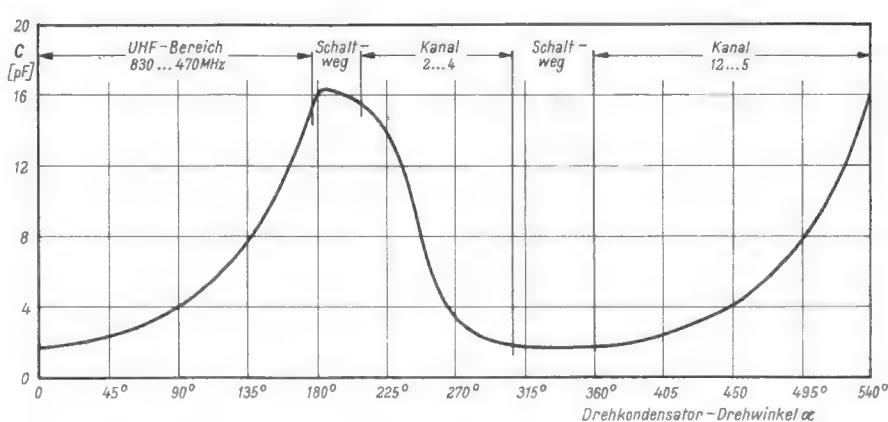
Bild 10. Kapazitätskurve der Drehkondensatoren mit  $540^\circ$  Drehwinkel für Einknopfbedienung nach Bild 9
