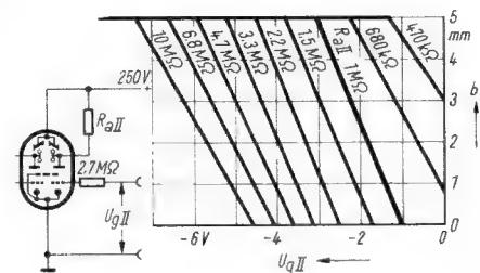
Bild 5. Anzeige-Kennlinien von System II
