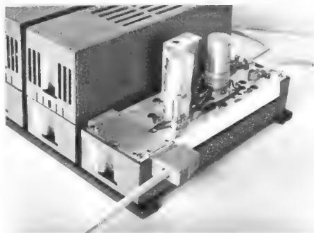
Bild 2. Frequenzumsetzer mit Verstärkern aus der Kompakt-Serie zusammen geschaltet (Kathrein)
