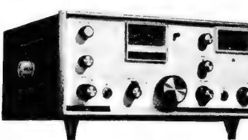
Sendeteil: SSB-Generator mit 5,2 MHz, Quarzfiltter, Input 200 W SSB, 180 W CW, 100 W AM. Autput 120 W SSB, 105 W CW, 30 W AM, Trägerunterdrückung 50 dB, Unterdrückung des 2. Seitenbandes 40 dB. Stabilität 400 Hz nach kurzer Einbrennzeit, AM-SSB: VOX- oder PTT-Betrieb. Benötigte Spannung: 700 V/300 mA, 280 V/100 mA, 80 V/10 mA, 12,6 V/5 A. 1960.—
