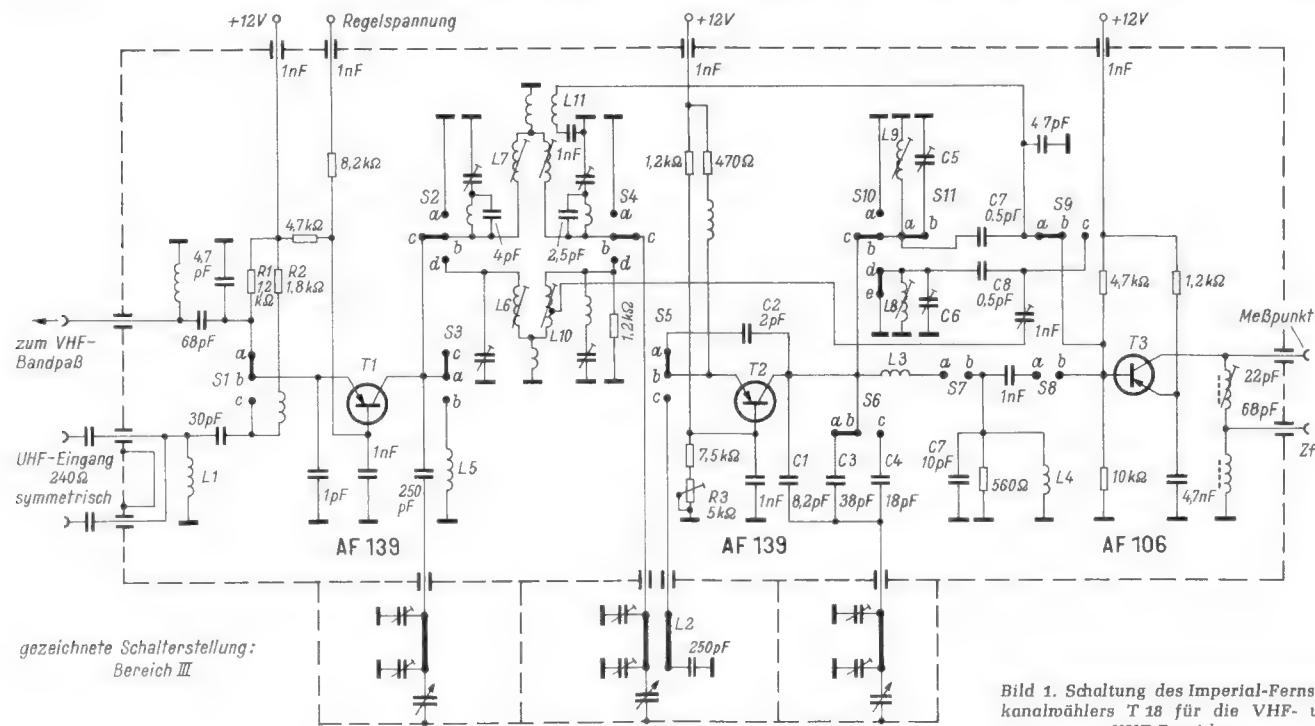
Bild 1. Schaltung des Imperial-Fernsehkanalwählers T 18 für die VHF- und UHF-Bereiche
