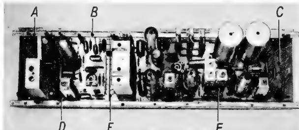
Dieser Schaltungsträger kann nun nach den Prinzipien der Bausteine in mehrere einzelne Platten unterteilt und durch einfache Elemente verbunden werden. Ohne auf die Vorteile der Baustein-Bauweise zu verzichten, läßt sich der unterteilte Schaltungsträger nach Belieben einzeln oder gemeinsam mit den Bauelementen bestücken, tauchlöten und prüfen.
