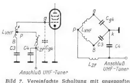
Bild 7. Vereinfachte Schaltung mit angezapfter VHF-Kreisspule
