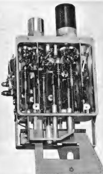
Bild 1. Ansicht des durchstimmbaren VHF-Tuners
