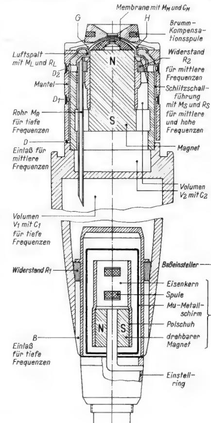
Bild 2b. Aufbau des Studio-Richtmikrofones MD 421. Erläuterung der Buchstaben im Text
