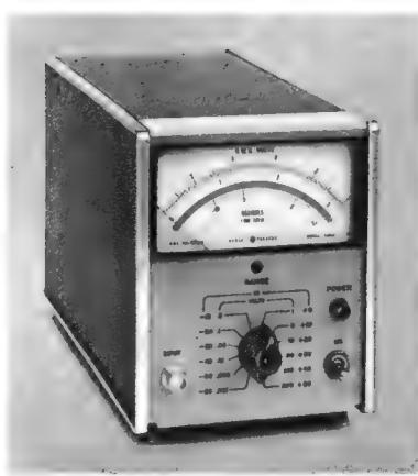
Links: Bild 6. Effektivwertvoltmeter 3400 A von Hewlett-Packard
