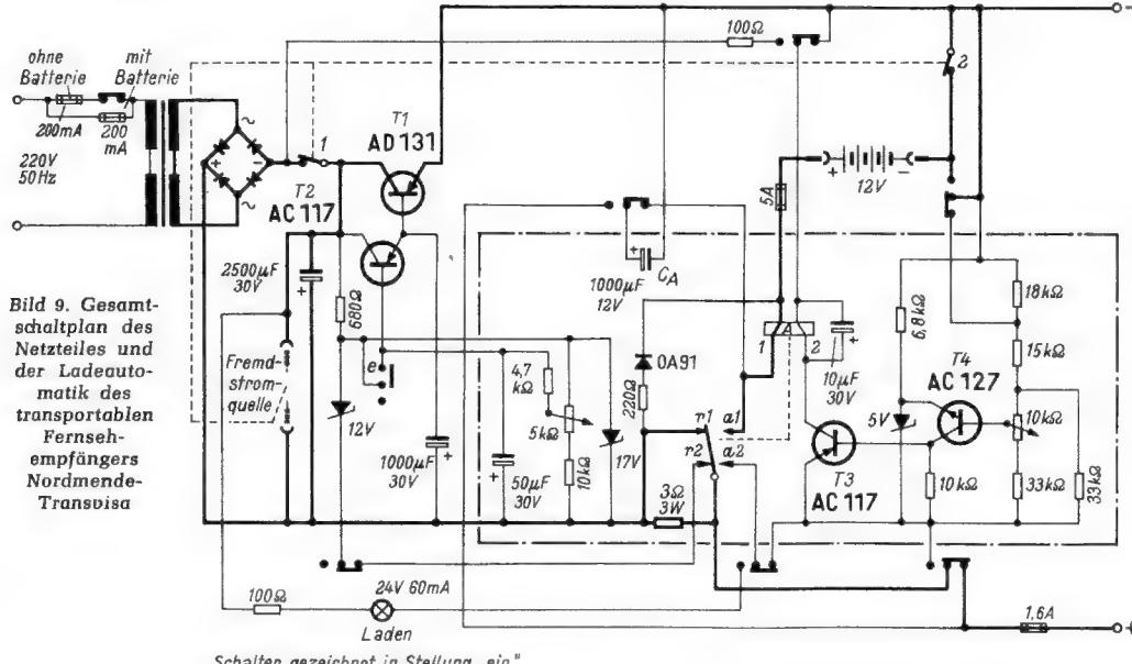
**Bild 9. Gesamtschaltplan des Netzteiles und der Ladeautomatik des transportablen Fernsehempfängers Nordmende-Transvisca**
