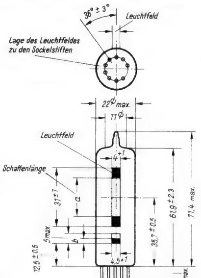
Bild 1. Kolben- und Leuchtbalken-Abmessungen
