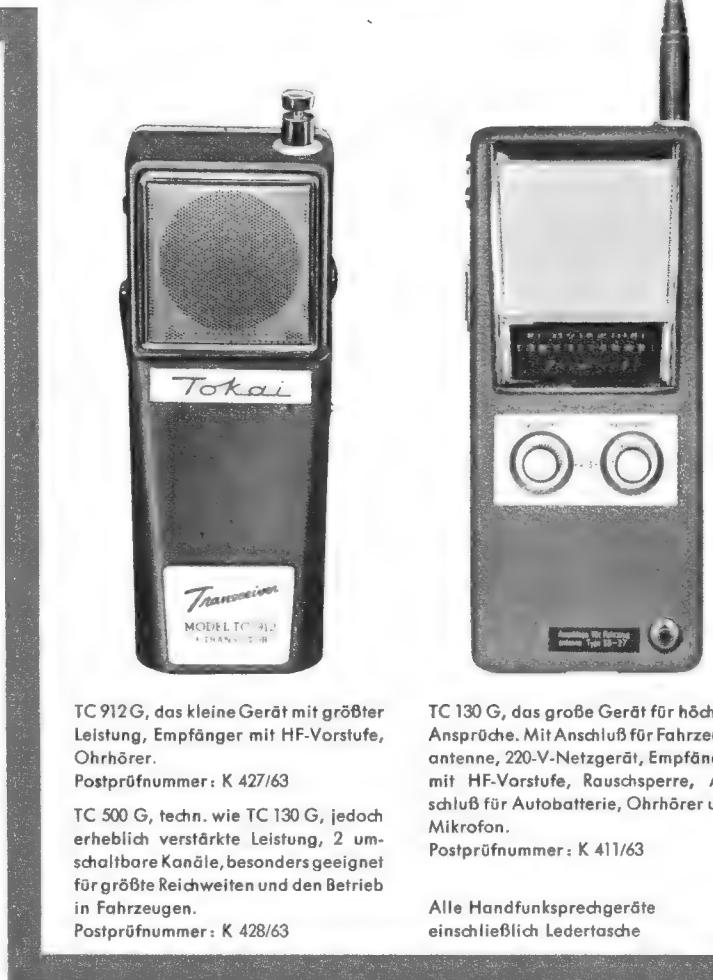
TC 912 G, das kleine Gerät mit größter Leistung, Empfänger mit HF-Vorstufe, Ohrhörer.
